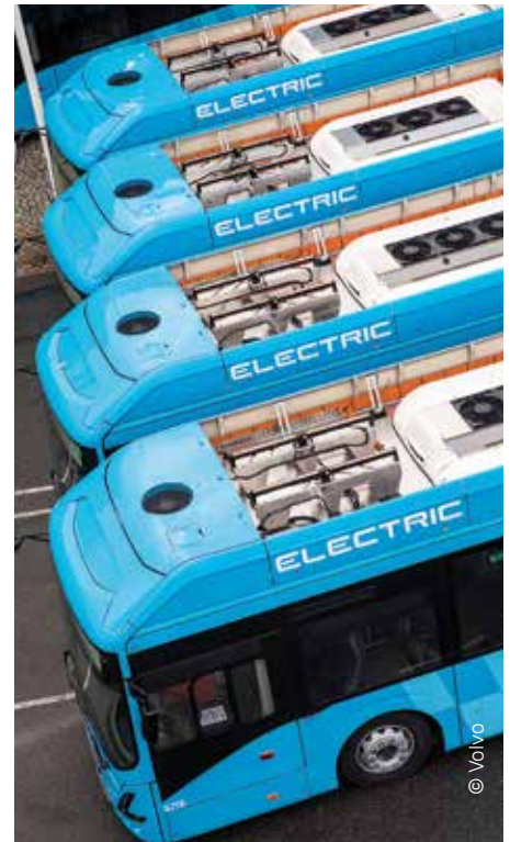
In de elektrische stadsbussen van Volvo zijn de batterijpakketten uit de vloer gehaald en in het dak geplaatst.
